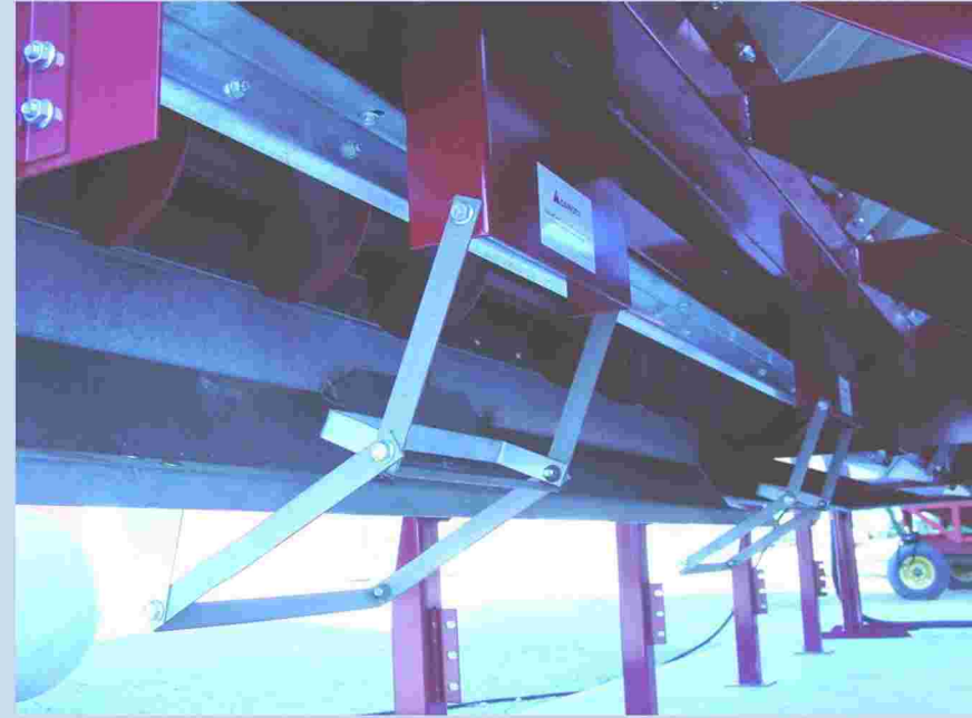
Люк для очистки выгрузного шнека (открыт)
