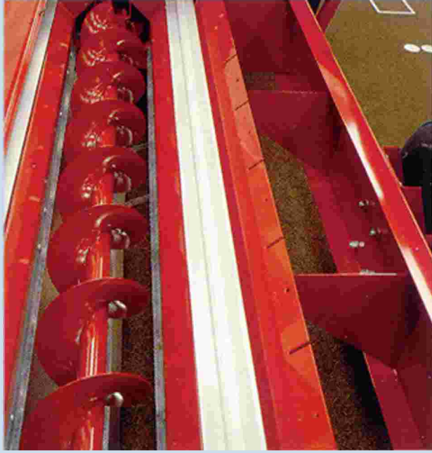
Выгрузной шнек: дозирующие алюминиевые ролики с поддонами из нержавеющей стали
